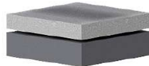
3. Горячее цинкование 40 - 150 мкм
