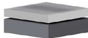
5. Термодиффузионное цин- кование с алитированием 40 - 70 мкм
