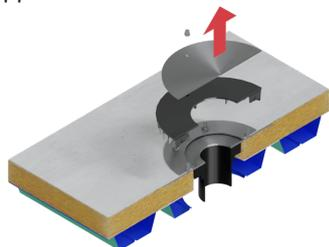
1. Снять с установленной на кровле воронки отсекающий воздух и листоуловитель.
