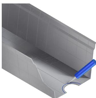
2. Отметить и выполнить отверстия в желобе для крепления корпуса воронки (4 отверстия по краям корпуса воронки). Нанести по периметру отверстия в желобе герметик в количестве необходимом для качественной герметизации.
