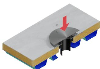
3. Пластиной отсекающего воздуха накрыть уплотнительное кольцо без установки листоуловителя, проследить за отсутствием смещения кольца относительно центра патрубка воронки.
