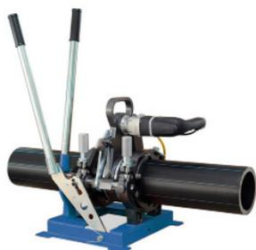
При помощи сварочного оборудования разогреть концы двух труб или фитинга (заготовок) до заданной температуры, соединить их под давлением и охладить соединение под давлением в течение определенного времени.
