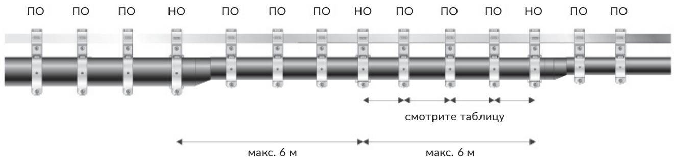
Размещение неподвижных опор на горизонтальных трубопроводах
