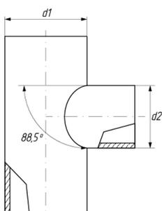
\*Допускается поставка сегментного фитинга (сварного)
