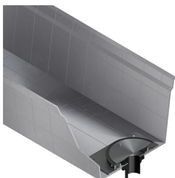
4. Разместить пластиковый листоуловитель по трём направляющим шпилькам и накрыть его металлическим отсекателем воздуха. Зафиксировать крепёжные болты отсекателя воздуха (3 штуки) с крутящим моментом 9,5 Нм.
