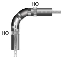
Размещение неподвижных опор при изменении направления на горизонтальных трубопроводах.
