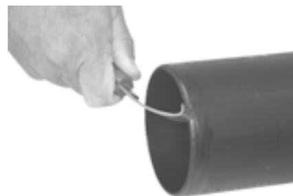
Соединение с компенсационным патрубком: с трубы снимается наружная фаска под углом 15°/ 30°.
