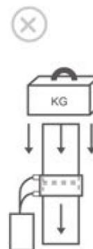
Убедитесь в отсутствии вертикального давления на трубу при сварке.
