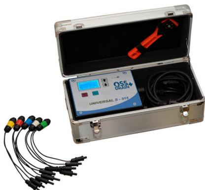
Сварка производится специальным инструментом использующим электрическое плавление для соединения полиэтилена. Допустимые модели сварочных машин и инструкции по их использованию вы можете запросить у персонального менеджера.
