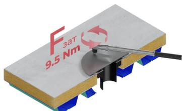
4. Зафиксировать тремя гайками М6 из комплекта отсекающий воздух над уплотнительным кольцом с крутящим моментом 9,5Нм, проследить за отсутствием смещения кольца относительно центра патрубка воронки.
