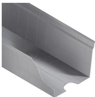
1. В соответствии с проектом отметить и выполнить в желобе отверстие для установки воронки диаметром 130 мм. Убедиться, что края отверстия ровные и не препятствуют плотному прилеганию корпуса воронки к дну желоба.
