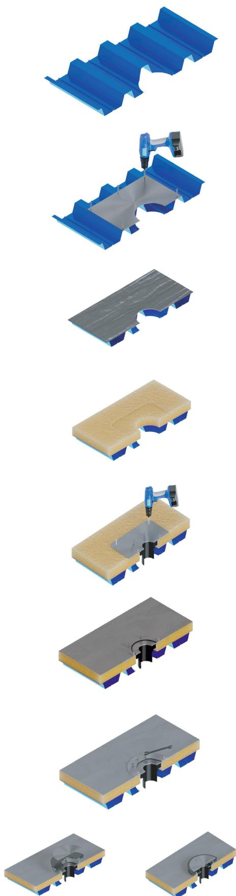
1. В соответствии с проектом отметить на крыше место расположения отверстия для установки воронки диаметром 130 мм. Убедиться, что указанная метка находится в нижней точке обслуживаемого воронкой участка кровли.
