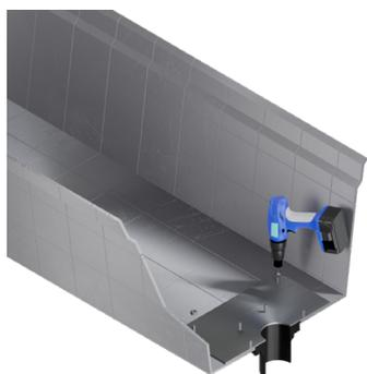
3. Установить корпус воронки (вместе с фланцевым элементом, предварительно удалив прокладку) в подготовленное отверстие в желобе и закрепить (крепёжные элементы в комплект не входят). Обеспечить плотное прилегание корпуса воронки к дну желоба, излишки герметика удалить.
