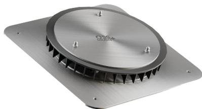
Ключевой компонент системы – это специальная воронка, имеющая в своей конструкции крышку-воздухоотсекатель, при помощи которой в трубопроводную систему при осадках большой интенсивности не попадает воздух, это позволяет сбалансировать гидравлические характеристики трубопроводов.
