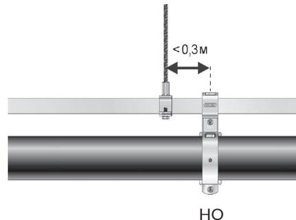
Максимальное расстояние от точки монтажа неподвижной опоры до подвеса шины
