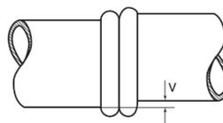
Взаимное смещение V сваренных труб не должно быть более 10 % толщины стенки трубы.
