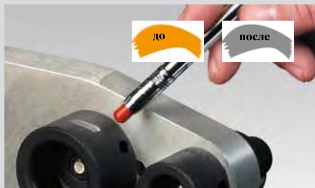
Контроль температуры нанесением штриха штифтовым индикатором температуры с изменением окраски
