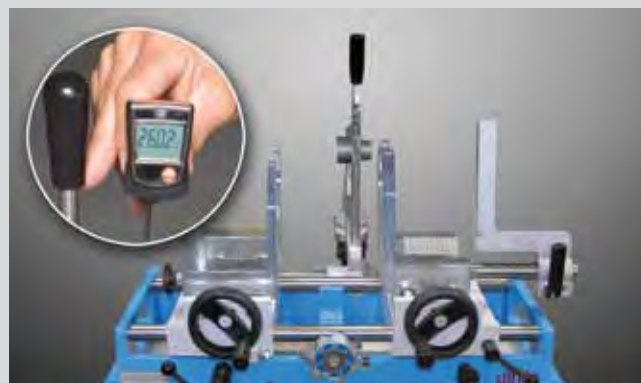
Измерение темп. на сварочном аппарате aquatherm
