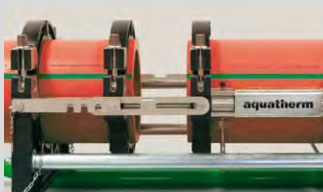
Свариваемые части вставить, выровнить и зафиксировать
