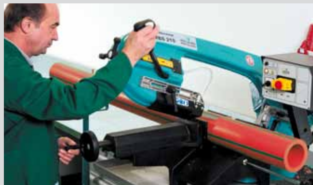
Перед сваркой отрезать трубу на необходимую длину
