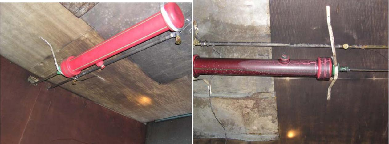
Рисунок ПД6 – Состояние трубы  $D_{\text{наруж}}$  125 мм до и после испытаний
