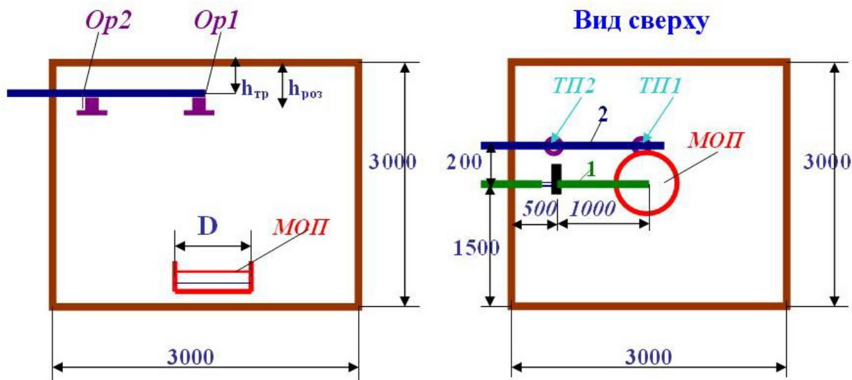
1 – испытываемая труба; 2 – металлическая труба со смонтированными спринклерными оросителями; Op1, Op2 – спринклерные оросители; ТП1, ТП2 – термопары; МОП – модельный очаг пожара
