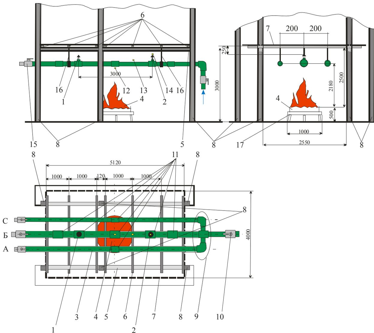
1 – ороситель Оп2; 2 – ороситель Оп1; 3 – испытываемые трубопроводы (А – DN 15, Б – DN 20, В – DN 10); 4 – МОП; 5 – горизонтальная балка; 6 – горизонтальная опора; 7 – фрагмент потолка; 8 – вертикальная балка; 9 – разветвление; 10 – входной шаровой кран; 11 – муфты; 12 – термопара ТП1; 13 – термопара ТП2; 14 – термопара ТП3; 15 – спускной шаровой кран; 16 – подвески- хомуты; 17 – подставка
