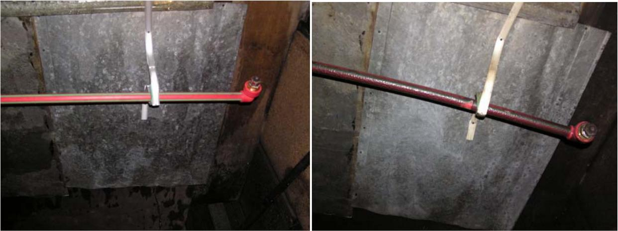
Рисунок ПД5 – Состояние трубы  $D_{\text{наруж}}$  32 мм до и после испытаний
