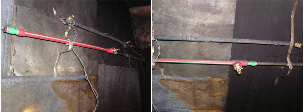
Рисунок ПД7 – Состояние трубы  $D_{\text{наруж}}$  32 мм с установленным на ней спринклерным оросителем до и после испытаний (максимальная температура пожара (190-230) °С)
