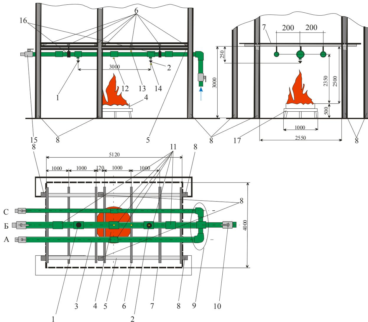
1 – ороситель Op2; 2 – ороситель Op1; 3 – испытываемые трубопроводы (А – DN 15, Б – DN 20, В – DN 10); 4 – МОП; 5 – горизонтальная балка; 6 – горизонтальная опора; 7 – фрагмент потолка; 8 – вертикальная балка; 9 – разветвление; 10 – входной шаровый кран; 11 – муфты; 12 – термопара ТП1; 13 – термопара ТП2; 14 – термопара ТП3; 15 – спускной шаровый кран; 16 – подвески-хомуты; 17 – подставка
